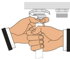
Закрутите вручную накидную гайку. Пластиковая, медная или металлопластиковая труба должна быть вставлена при этом до упора.
