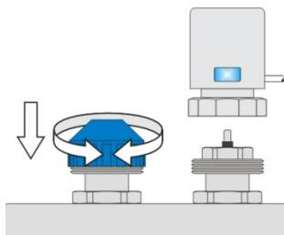
После окончания регулировки защитный колпачок или сервопривод устанавливаются на регулирующий клапан, препятствуя, таким образом непроизвольной перенастройке или загрязнению клапана.
