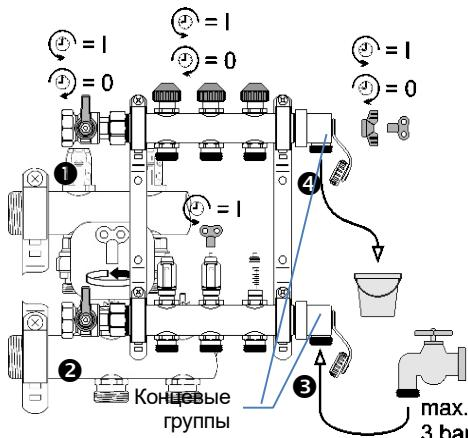
Закройте шаровые краны ①+②. Подключите шланг для наполнения и промывки к сливному крану концевой группы ③ подающего коллектора; сливной кран концевой группы ④ обратного коллектора должен быть полностью открыт!
