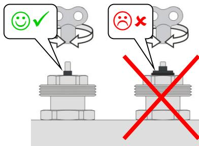
Мелкая резьба регулирующего шпинделя не должна выступать выше шестигранника SW19! Для полного открытия клапан из полностью закрытого состояния необходимо 2,5 - 3 оборота шпинделя против часовой стрелки (максимальный расход).
